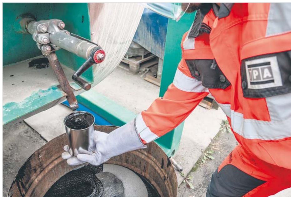
Asfalt, użyty przy budowie trasy, został specjalnie zmodyfikowany za pomocą gumy z zużytych opon
